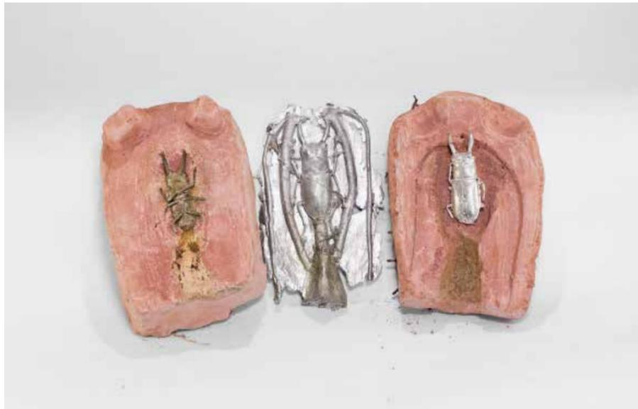
Fig. 2 - Moule et expérimentation de fonte d'un scarabée, 2015, Columbia University, New York.
